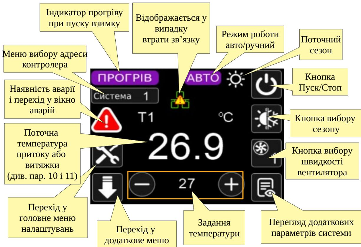
В процесі роботи, пульт постійно опитує підключений контролер і відображає всі дані на екрані. Контролер можна обрати, натиснувши кнопку «Система», після чого необхідно обрати номер контролера, інформація про який стане доступною після натискання кнопки «Задати».
