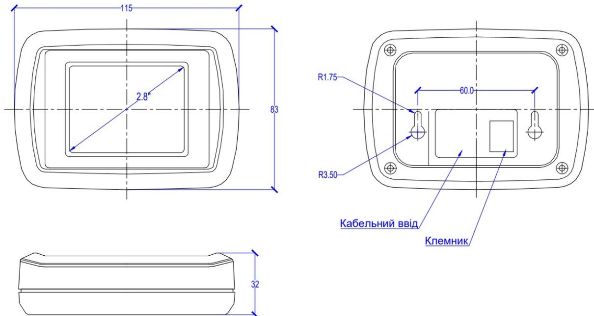
Пульт можна встановити на металеву панель, наприклад на двері щита автоматики. Для цього потрібно зняти задню кришку панелі, відкрутивши 4 саморізи. У металевих дверях потрібно зробити отвір  $\varnothing 32$  мм і 4 отвори  $\varnothing 3$  мм (див. малюнок нижче). Передня частина корпусу пульта прикручується комплектними саморізами прямо до металевих дверей щита, при цьому роз'єм, що виступає, розміщується в отвір  $\varnothing 32$  мм.
